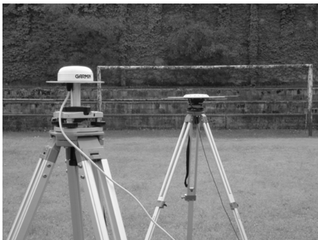
Fig. 1 – antenna GARMIN con adattatore e determinazione della posizione del centro di fase
